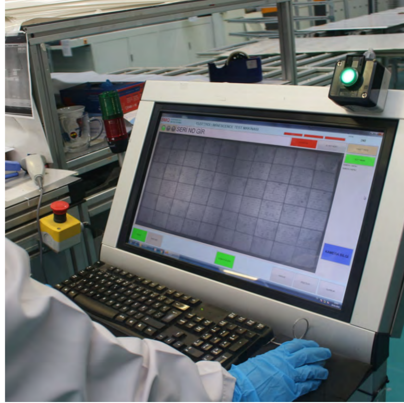
Laminasyon öncesi ve sonrası %100 Electroluminesans testi ile mikro çatlakların eliminasyonu.
