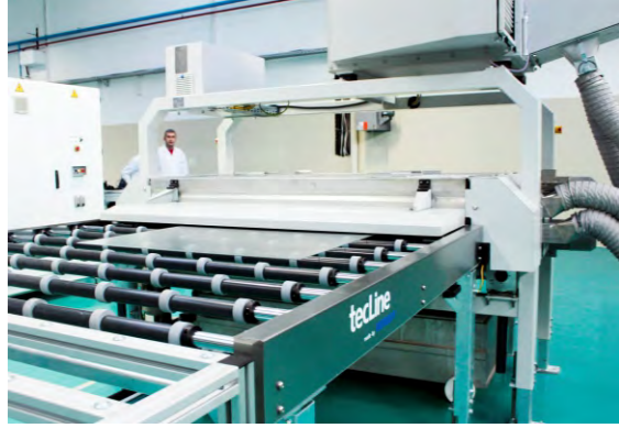
De-iyonize cam yıkama sistemi ile temiz üretim.
